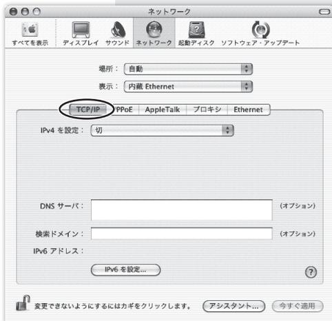
4 TCP/IP タブでは、IPv4 を設定：「DHCP サーバを参照」を選びます。
